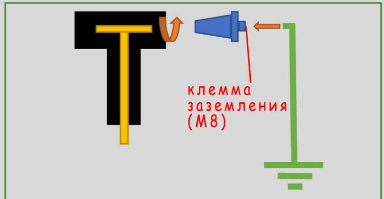
Датчик напряжения должен быть заземлен посредством провода сечением не менее 6 мм<sup>2</sup>
