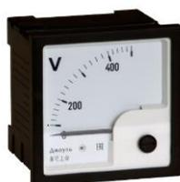
Вольтметры аналоговые щитовые А48, А72, А96, А144 и модульные А35 используются для измерения напряжения переменного тока промышленной частоты. Выпускаются как приборы прямого включения на напряжение: 6, 10, 15, 25, 40, 60, 100, 150, 250, 300, 400, 500, 600 В, так и трансформаторного включения на напряжение 100 или 110В. Приборы трансформаторного включения комплектуются сменными шкалами. Диапазон измерения приборов трансформаторного включения определяется шкалой.
