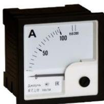
Амперметры аналоговые щитовые А48, А72, А96, А144 и модульные А35 используются для измерения силы переменного тока промышленной частоты. Выпускаются как приборы прямого включения на ток: 1, 1,5, 2,5, 4, 5, 6, 10, 15, 20, 25, 30, 40\*, 50\*, 60\* А, так и трансформаторного включения на ток 1 или 5 А. Приборы трансформаторного включения комплектуются сменными шкалами. Диапазон измерения приборов трансформаторного включения определяется шкалой.
