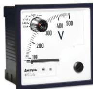
Амперметры А72К, А96К и вольтметры В72К, В96К со встроенным переключателем предназначены для использования в трехфазных сетях переменного тока промышленной частоты. Встроенный в прибор переключатель позволяет выбирать нужную фазу для индикации на приборе. Для вольтметра возможно измерение трех фазных и трех линейных напряжений одним прибором.
